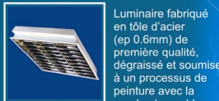
Luminaire fabriqué en tôle d'acier (ep 0.6mm) de première qualité, dégraissé et soumise à un processus de peinture avec la poudre époxy blanc polyester (RAL 9003).
