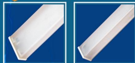
Diffuseur Nid'abeille fabriqué en tôle d'acier (ep 0.6mm) de première qualité, dégraissé et soumise à un processus de peinture avec la poudre époxy blanc polyester (RAL 9003).
